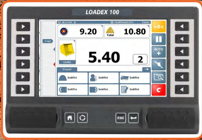
Un système de pesage embarqué performant et intuitif pour pelles à pneus et à chenilles permettant de peser le contenu d'un godet, d'un grappin ou d'une pince.
